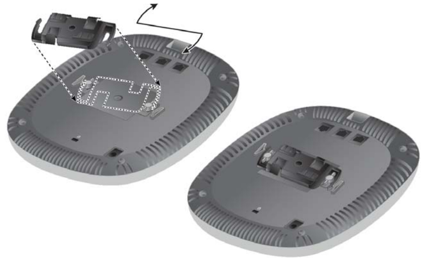
Figura 6 Acoplando o adaptador do trilho para teto
